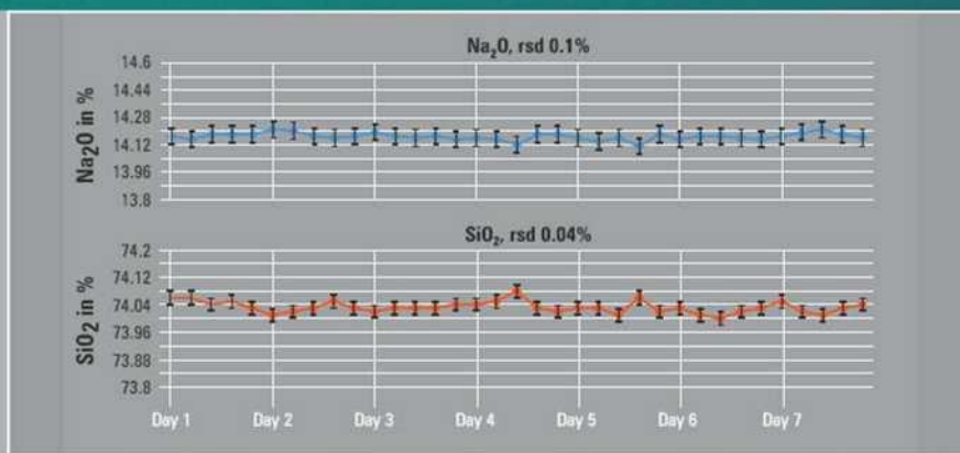
Doskonała stabilność długookresowa: Próbka szkła analizowana 35x w ciągu 7 dni
